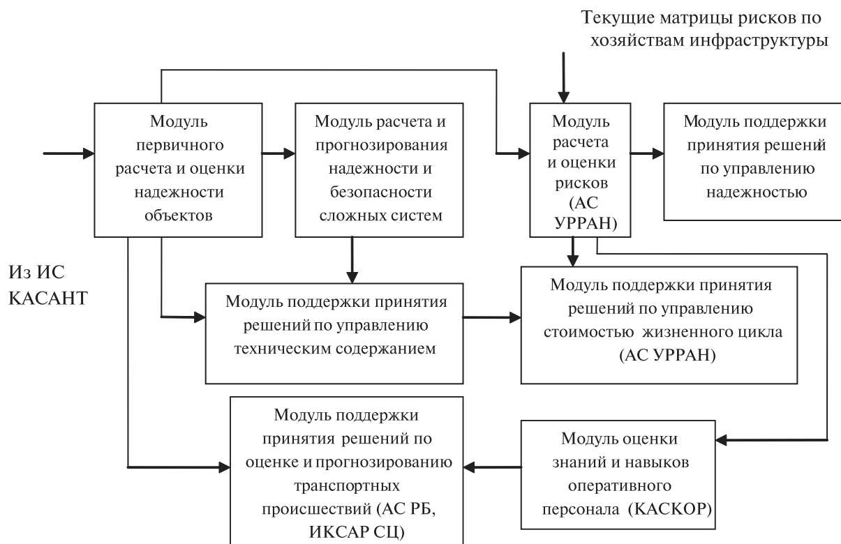
Рис. 2. Структура математического обеспечения системы управления надежностью, ресурсами, прогнозирования транспортных происшествий и управления чрезвычайными ситуациями на железнодорожном транспорте
